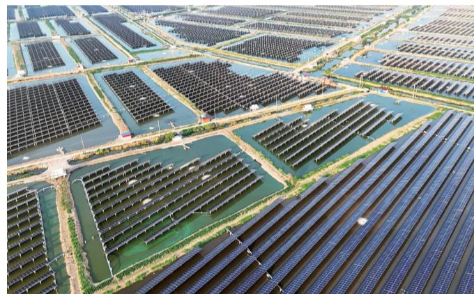
7月31日，位于连云港市赣榆区墩尚镇境内的江苏省规模最大的940兆瓦渔光互补新能源项目进入扫尾施工。该项目总投资约54.3亿元，将光伏发电和渔业养殖结合起来，形成“水上发电、水下养殖”的产业模式。
