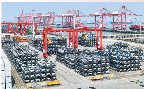
太仓港国际集装箱码头，2500余台国产品牌燃油车及新能源车正通过“可折叠商用车专用框架”海运新模式装运到“中远海运开拓”轮，即将出口发往欧洲多个港口。今年前2个月，太仓港通过框架运输方式完成11889台商品车发运任务，预计全年通过框架运输方式将完成10万台商品车发运任务。
