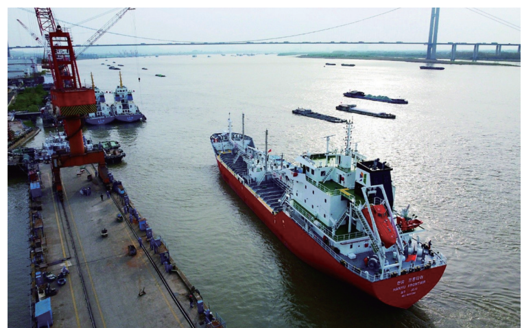
▲鎮江船廠為韓國船東建造的4499噸重噸液態硫磺運輸船日前順利啓航。該船船長99.9米，有2個獨立的硫磺罐體，裝載容量達到2800立方米，運輸能力4499噸，配備了先進的熱風加熱系統，是一型達到國際先進水平的化學品運輸船。
